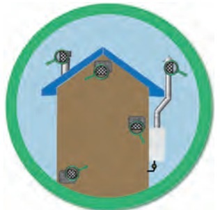
Figura 14. Cubierta con malla alambre fino.
