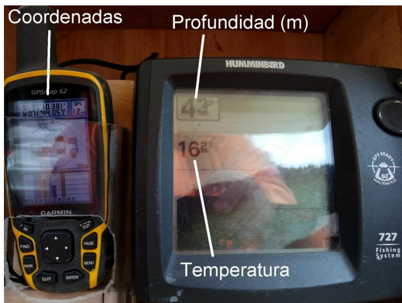
Figura 2. Foto de la ecosonda Humminbird 727 y del GPS Garmin GPSmap 62
